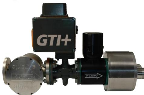
Com uma pressão de saída negativa, o desenho permite que o sistema use um esquema de controle de "demanda" em que o fluxo de ar de admissão do motor determina o fluxo de gás do motor. Como as mudanças de carga do motor, as alterações correspondentes no volume de ar de admissão arrasta automaticamente combustível adicional para o misturador.
